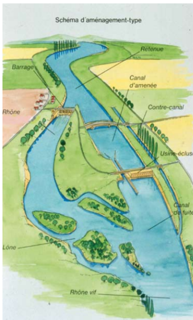
Illustration 4.3: Schéma type d'aménagement type de la CNR ((c) photothèque CNR _ ZABR, 2008)
